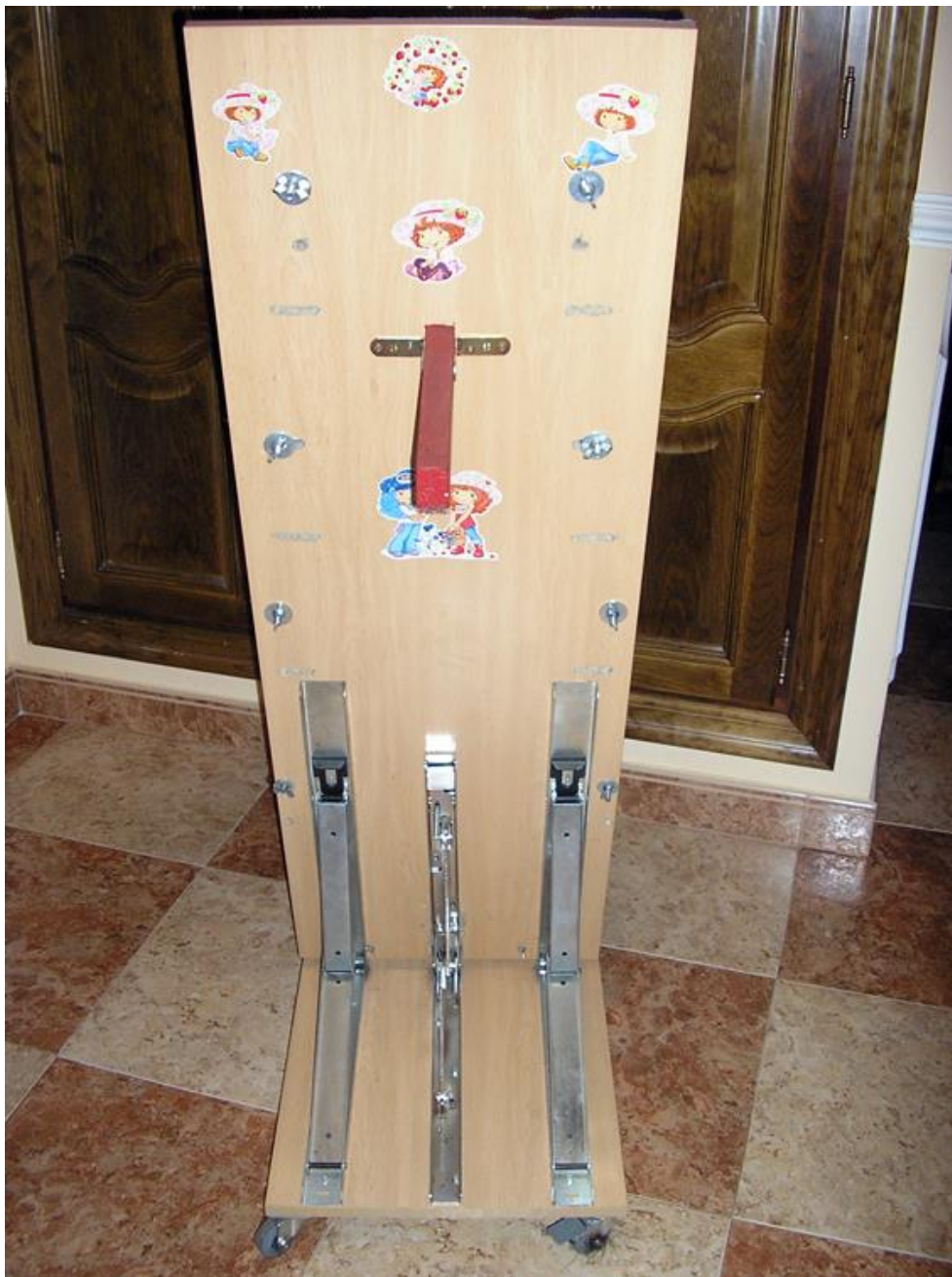
Detalle de la vista posterior del plano en la que se aprecia cómo están colocadas las bisagras.
