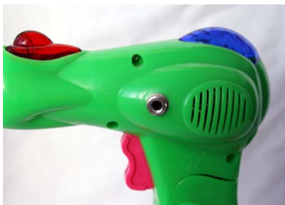
Vista de detalle del jack hembra para conectar el pulsador.
