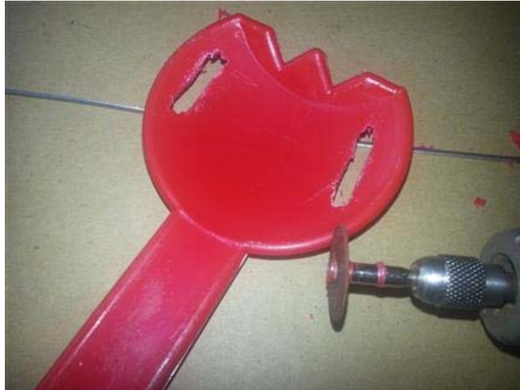
Se abren huecos en el cucharón para el paso del velcro
