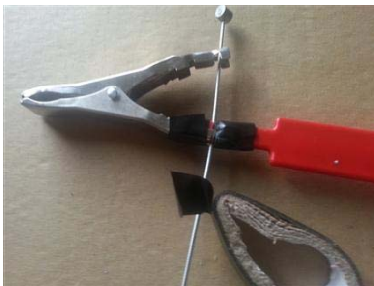
Pasamos el alambre del freno de bicicleta y lo amarramos del otro lado en el cucharón.
