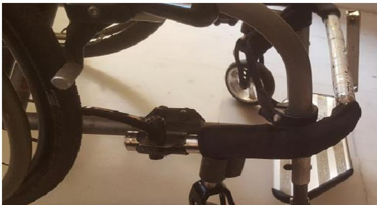
2. Insertar la pieza1 dentro de la pieza2: primero en el orificio superior colocándole el tornillo con manivela de baquelita de Pieza4 apretando con su pomo correspondiente. (todavía las ruedas delanteras de la silla de ruedas siguen apoyadas en el suelo)
