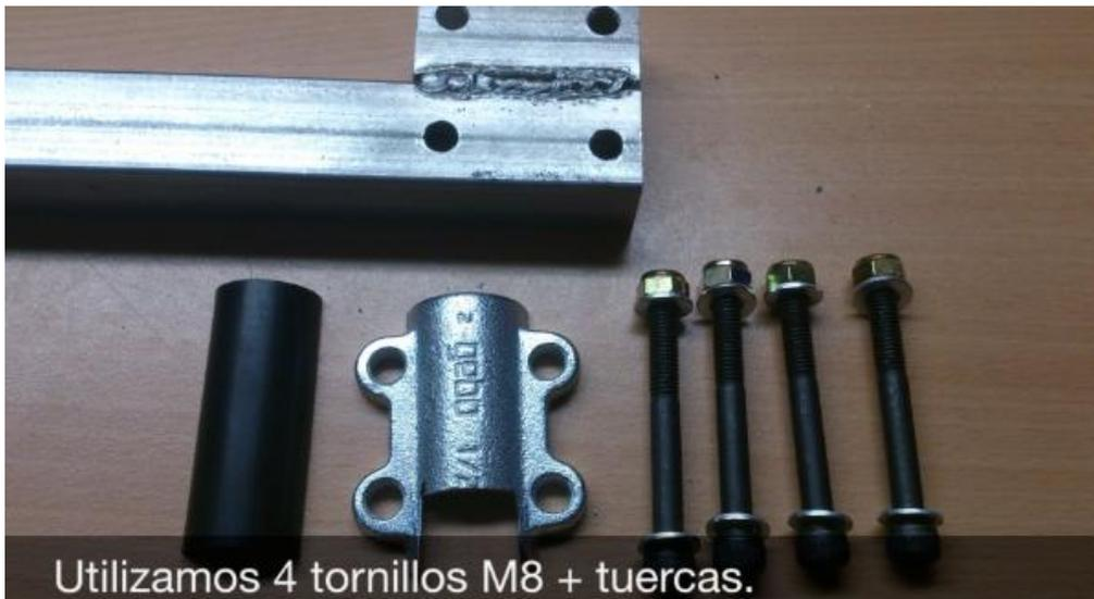
Imagen de los tornillos utilizados (M8) con sus tuercas.
