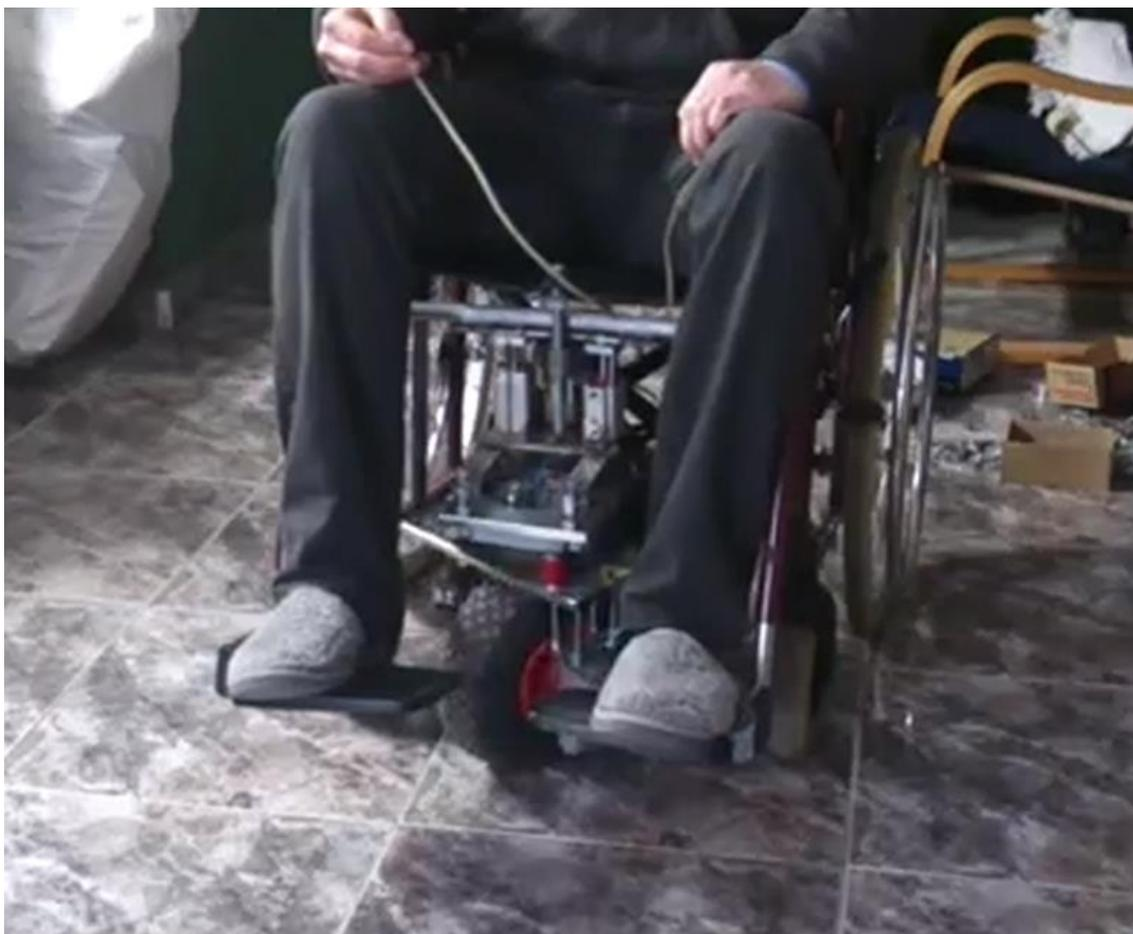
Imagen de silla de ruedas manual a la que se ha colocado una rueda motorizada en su parte central anterior.
