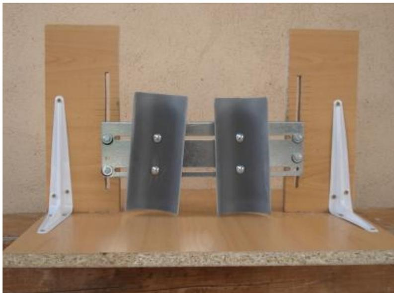
Material: pletina metálica con railes (o tabla), 4 tornillos de 6 mm de diámetro y 4 cm de largo de rosca hasta el final, 8 arandelas metálicas, 4 palomillas.
