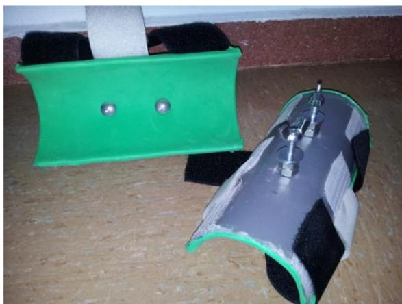
Material: Velcro de pegar, velcro de coser, 4 tornillos con cabeza lisa de 6cm de largo y 5mm de diámetro, 8 arandelas y 4 palomillas.
