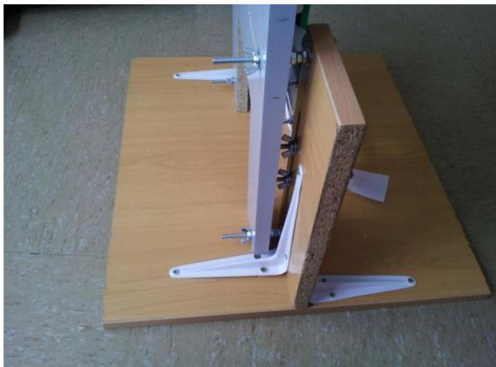
Material: tabla de respaldo con opción de railes para controlador lateral. 4 tornillos de 5mm de diámetro y 100 mm de largo. 12 arandelas. 4 palomillas para los tornillos.
