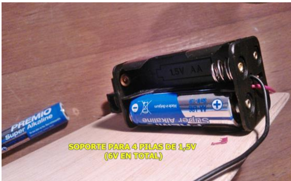
Caja de pilas.
