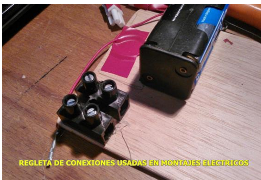
Regleta de conexiones que une las pilas con el circuito.
