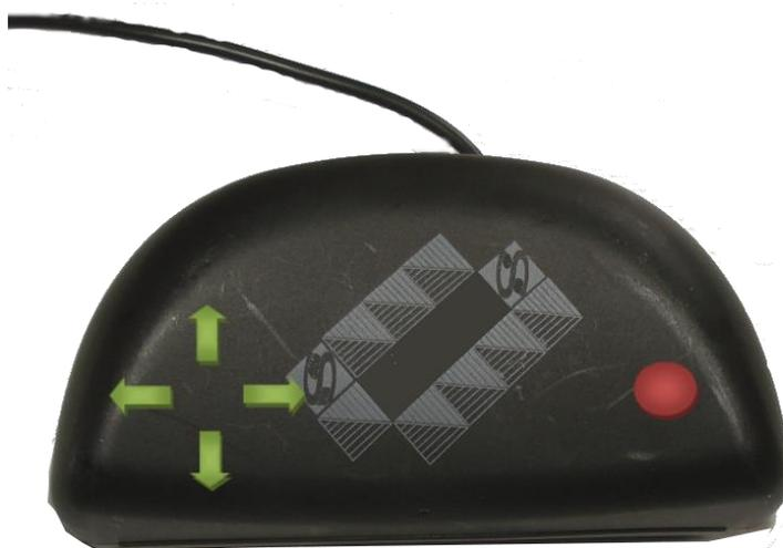
Esta adaptación permite utilizar las funciones del mouse (mover el puntero y clic izquierdo). Para ello, se adapta el joystick convencional para computadora con conexión USB, desarmándolo y creando uno nuevo a partir de sus componentes; además se utiliza, una caja de plástico, sensores del tipo “Reed Switch”, un imán de neodimio y el programa “Mouse Joystick”<sup>3</sup> de Jordi Lagares, donde podremos controlar el mouse mediante un joystick convencional.
