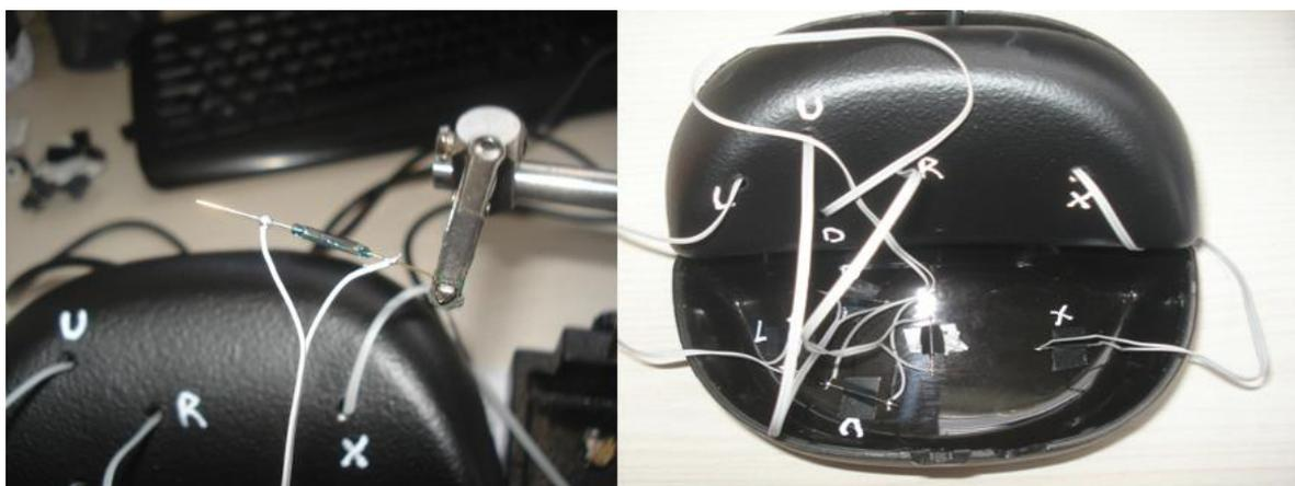
Al pegar los sensores debemos respetar la distancia aproximada de 1,5 cm entre ellos. De no ser así, corremos el riesgo que el imán active más de un sensor a la vez. Técnica que podremos aplicar para activar el desplazamiento en diagonal cuando la persona se acostumbre a usar el dispositivo.
