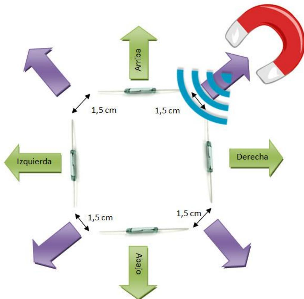
Para alcanzar los desplazamientos básicos arriba, abajo, izquierda y derecha, bastará con colocar el imán sobre el sensor que corresponda como muestra la siguiente imagen.
