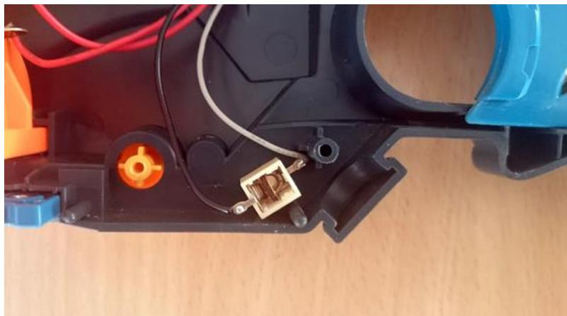
Se sueldan los cables a los terminales del interruptor que acciona disparo. Luego se sueldan a un Jack mono de 3.5 hembra de chasis y se coloca la salida fijándola con pegamento de contacto instantáneo.
