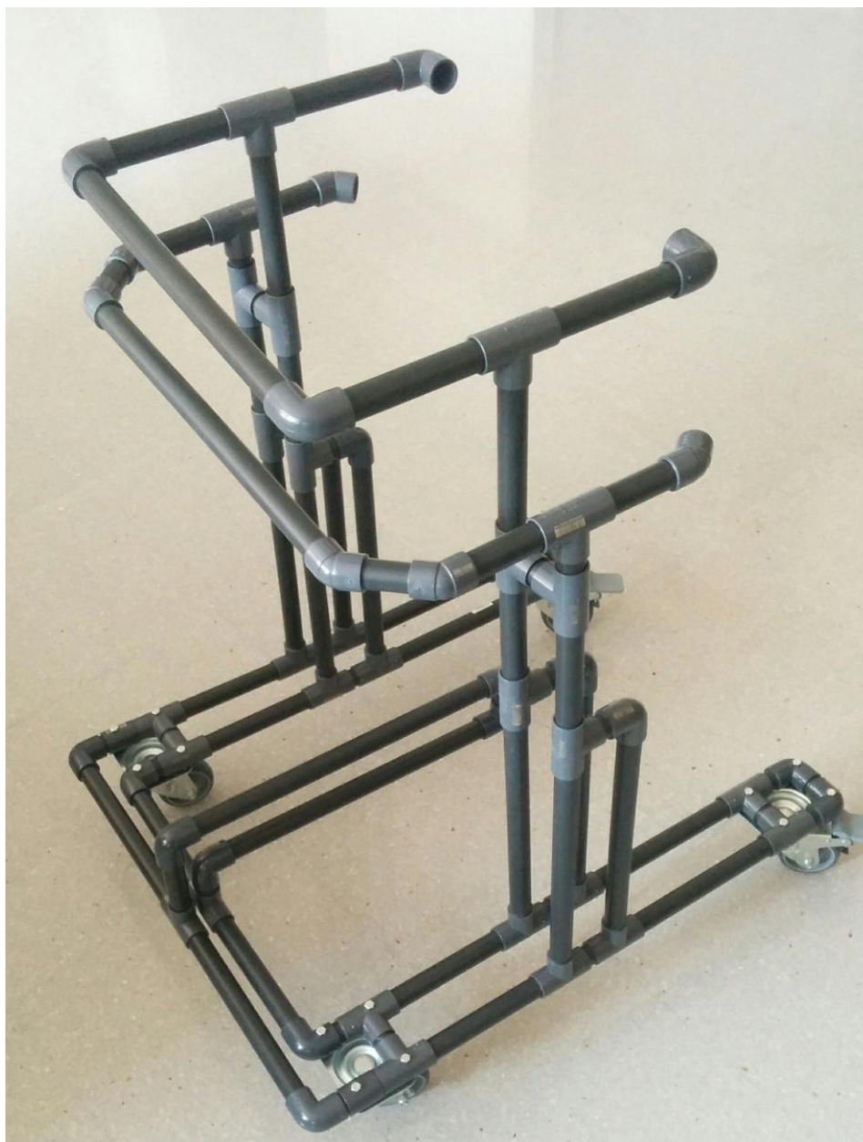
Primer prototipo del caminador, con el separador de piernas instalado.
