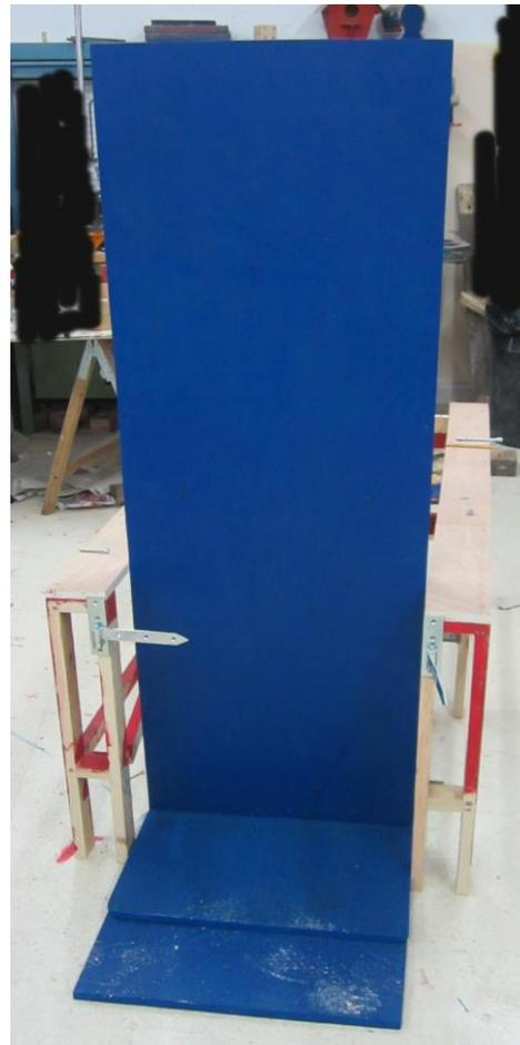
Vista posterior de la estructura y el tablero. Bisagras dentadas con tirador para desbloquearlas. En la estructura se aprecian los tirantes que facilitaran su plegado y el eje.
