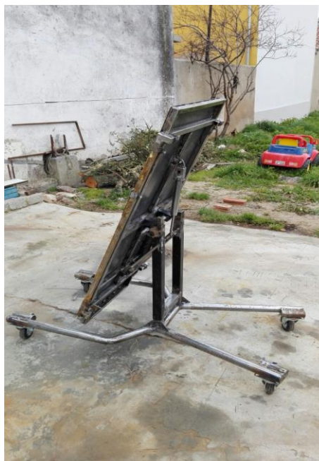
Finalización de la base del chasis y comienzo de los trabajos en la plataforma inclinada regulable.
