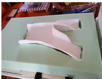
Prueba de encaje de molde en colchón antes de pegarlo con la espuma de poliuretano.
