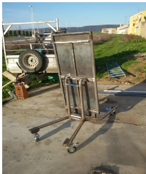
Trabajos de soldadura del chasis del mecanismo.
