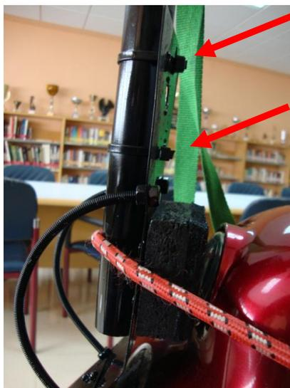
Cuando tenemos colocado el trípode en la pletina vemos que con el movimiento del cuadriciclo se balancea la cámara. Para darle solidez le colocamos una madera con espuma entre la pletina y el faro del cuadriciclo y le pasamos un tensor sujeto al manillar. En la siguiente foto se aprecia el trozo de madera fijado a la pletina y el tensor sujeto al manillar.
