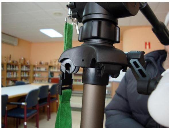
Para fijar el trípode a la pletina hemos tenido que hacer algunos agujeros a la pletina y a la parte baja del tubo del trípode para poner remaches (en la parte baja) y bridas resistentes (en la parte alta). Las bridas se pueden ver en esta foto.
