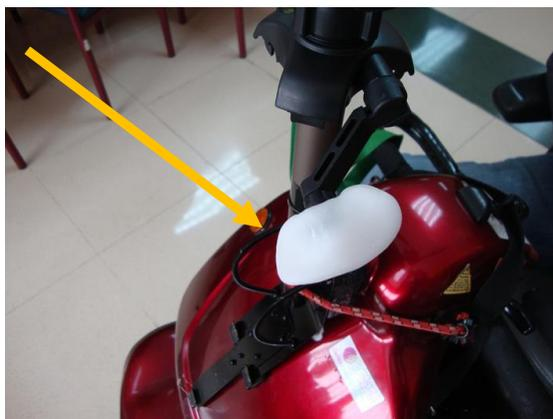
Otra dificultad era activar el PLAY y el STOP de la grabación en el móvil. Para solucionarlo utilizamos el mando a distancia del SELFIE pero éste es tan pequeño que a Juan Carlos le era muy difícil sujetarlo y activarlo con facilidad. Para ello colocamos este mando al final de un tubo de PVC, sujeto con SUGRU, y en el botón de PLAY/STOP le pusimos una gota de silicona sólida.
